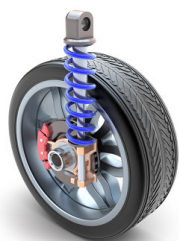
Figure 2 – Schéma d'un amortisseur
